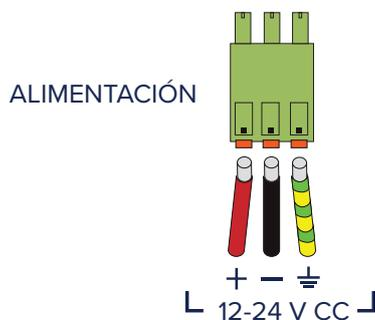
El Receiver debe alimentarse con 12–24 V CC. Una vez conectado, el indicador luminoso verde en el lado izquierdo del conector de alimentación se encenderá.
