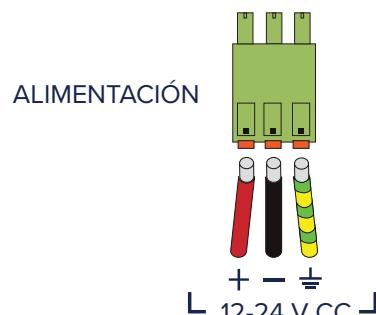
El Receiver debe alimentarse con 12–24 V CC. Una vez conectado, el indicador luminoso verde en el lado izquierdo del conector de alimentación se encenderá.
