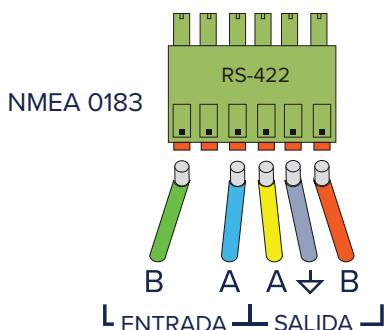
Para conectarse a un sistema de cartas electrónicas, utilice el conector NMEA 0183 suplementado. ENTRADA y SALIDA en la figura se muestran desde la perspectiva del RA10 Receiver.
