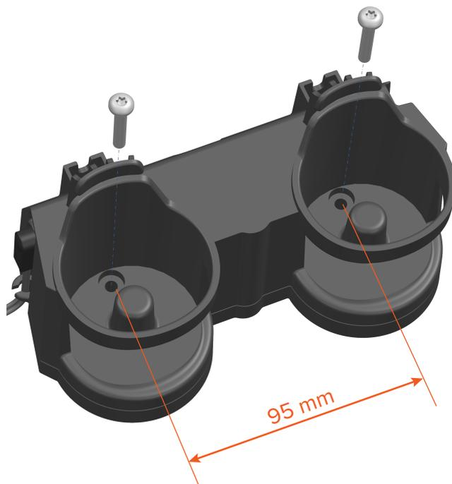
**3.** Fije el cargador a la pared insertando los dos tornillos inferiores.
